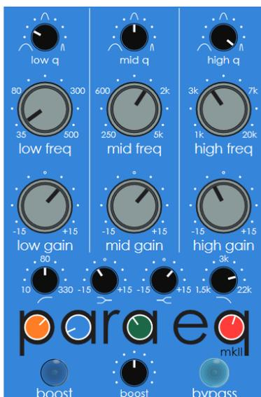
ハイゲインの歪みを抑えるために、ローをわずかにカットし、ミッドとハイをブーストします。周波数特性をシャープにし、フラットなサウンドを実現したセッティング例です。
