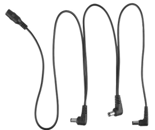
↑DC 分岐ケーブル/パラケーブルの使用は <絶対に禁止> です！
