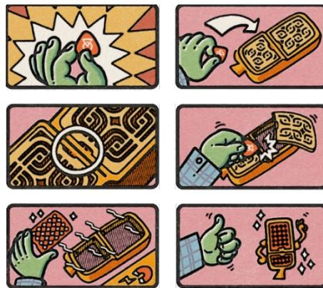
スクリーンを取り付ける際は、まずスクリーンの切り欠きがある一边を、スクリーン取り付け位置下側の一边に合わせます。その後、合わせた辺をずらさないようにスクリーンを本体に近づけ、取り付けます。「パチッ」とマグネットにくっつき、マイク本体とスクリーンが平面になるようにはまっていればOKです。
