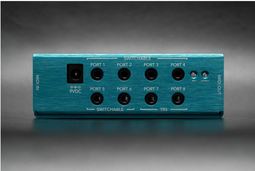
**9VDC** - 電源を接続します。9VDC センターマイナス、20mA。故障の原因となるため 9V の電源のみを接続してください。
