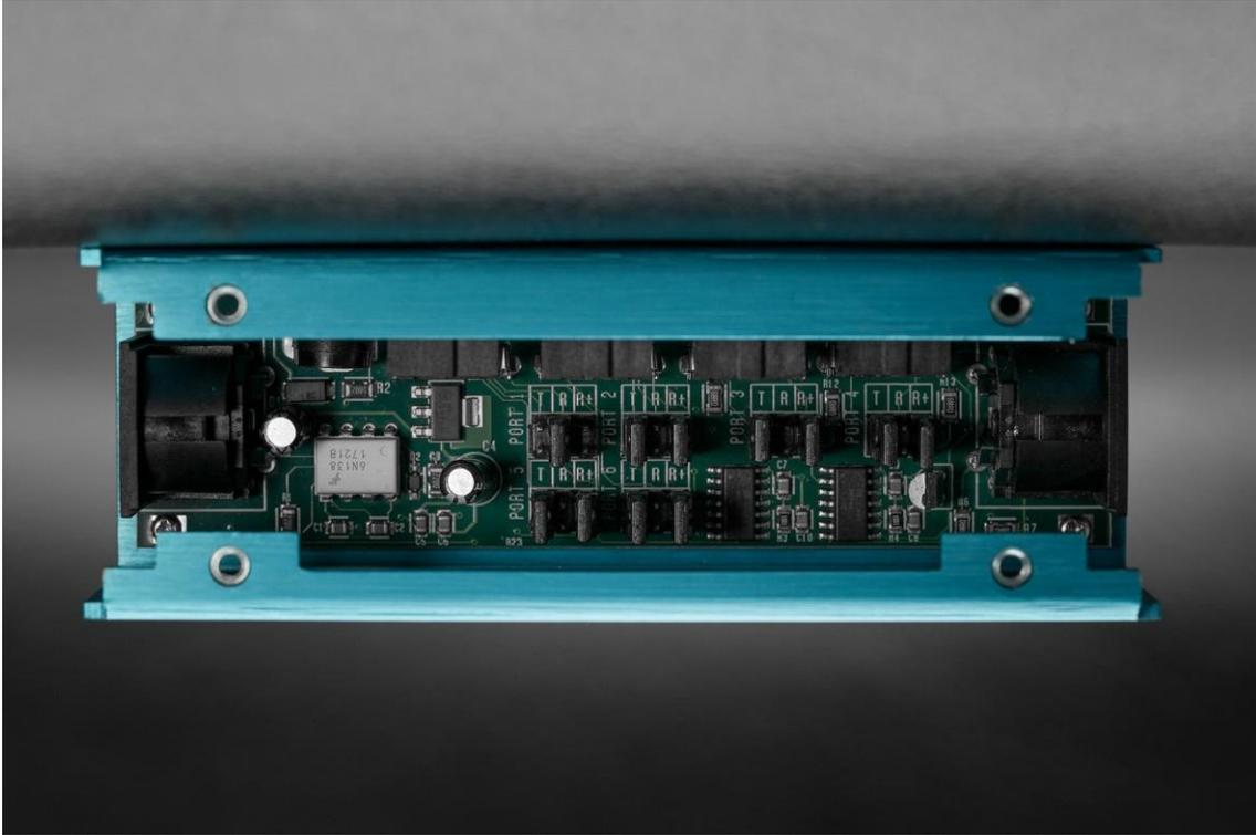
内部ジャンパースイッチはポート 1 から 6 の送信方法を MIDI via ring または via tip から選択できます。またいくつかのデバイスで必要な ring powered または floating も設定できます。このジャンパースイッチ設定により、MIDI BOX は全ての MIDI TRS デバイスとの接続を可能にしています。
