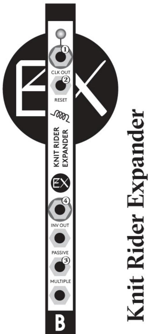
1、Clock out 端子は Knit Rider がステップごとに発するパルスを（1 ステップ=4 サブステップ）出力します。また信号に応じて LED が光ります。
