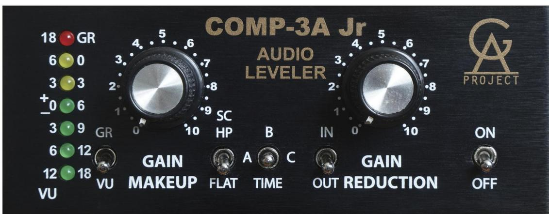
「COMP-3A Jr」の信号パスには抵抗、コンデンサ、ダイオード、トランジスタなどのディスクリートのコンポーネントのみが使用され、入出力はそれぞれに最適化されたトランスフォーマー・バランスのデザインが採用されています。IC 回路は一切使用されていないクラシックな回路設計は本機の音質を決定付けています。COMP-3A Jr の持つ音楽的なビンテージサウンドは、デジタルレコーディング全盛の今だからこそ評価される音質を提供できます。
