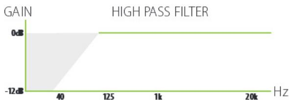
ハイパス・フィルターは設定した周波数より上の帯域だけを通過させるフィルターです。設定した周波数より低い帯域をカットするフィルター、つまりローカット・フィルターとも解釈することができます。FELiX2には、他のGRACE designのレコーディング機器にも採用されている、-12dB/octのTompson Butterworthレスポンスのロールオフ設計を採用、パスバンドのフラットさとタイムドメイン・レスポンスのコンビネーションに優れた音質を実現しています。
