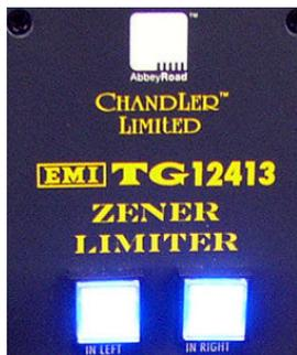
各チャンネルには自照タイプのプッシュボタンのバイパススイッチが備わっておりバイパス音とコンプレッションされたサウンドをスイッチング切替できます。
