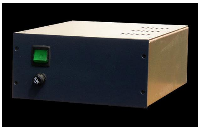
専用の別売 3amp 仕様の外部パワーサプライを使用します。以下のような構成になっています。
